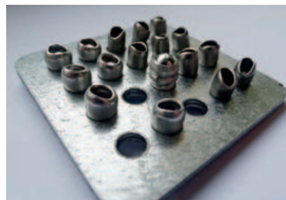
Fot. 6. Osadzony nit wielozakresowy na tle standardowych nitów zrywalnych
