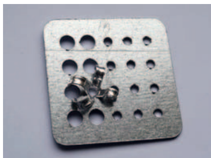
Fot. 8. Nit zrywalny rozwidlający się
